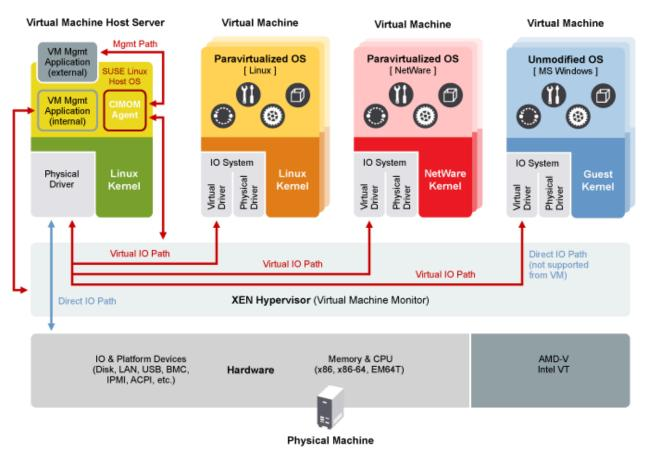
FIGURE 3.1: XEN VIRTUALIZATION ARCHITECTURE
